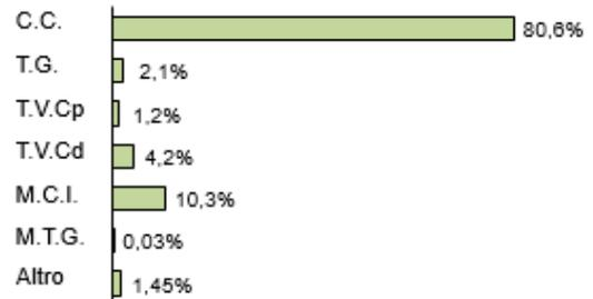
Figura 4 - Capacità di generazione elettrica delle unità di teleriscaldamento sul totale delle unità di cogenerazione.
