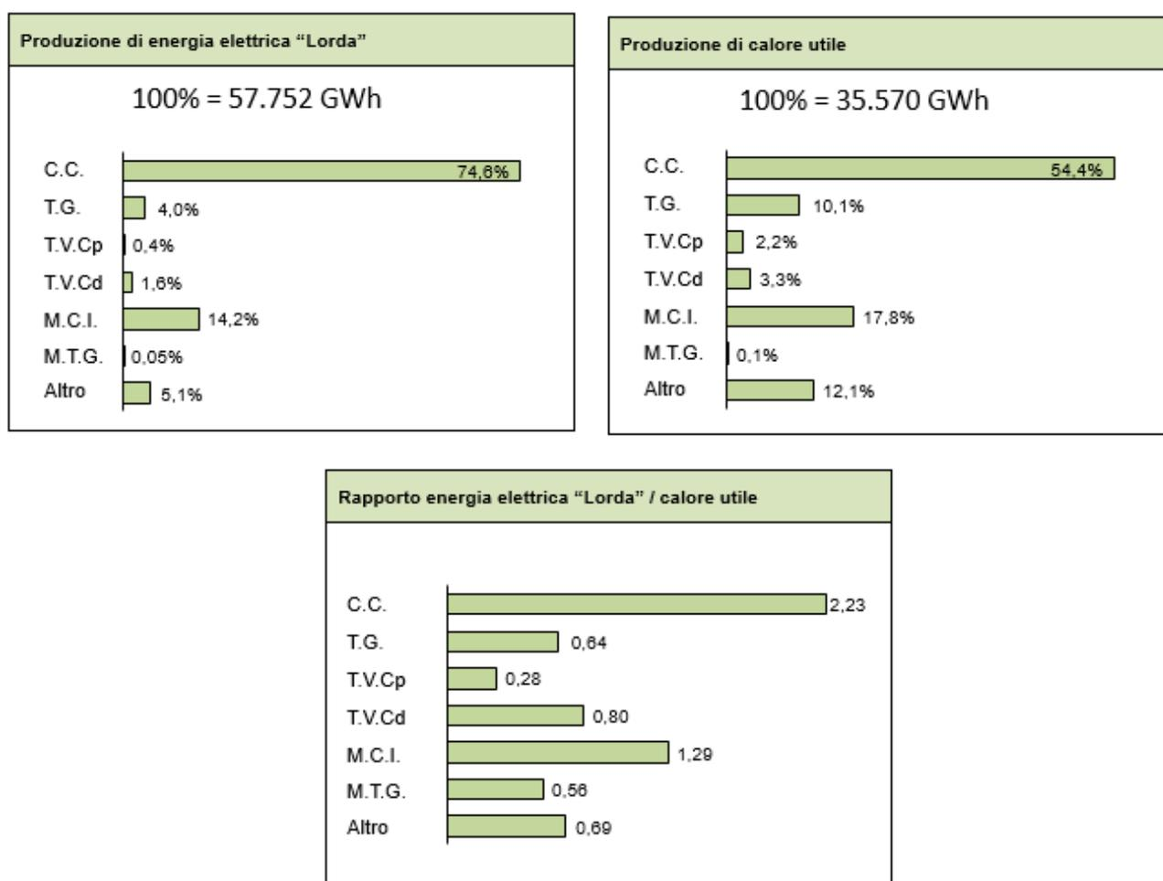
Figura 2 - Produzione elettrica e termica; rapporto energia elettrica lorda / calore utile.
