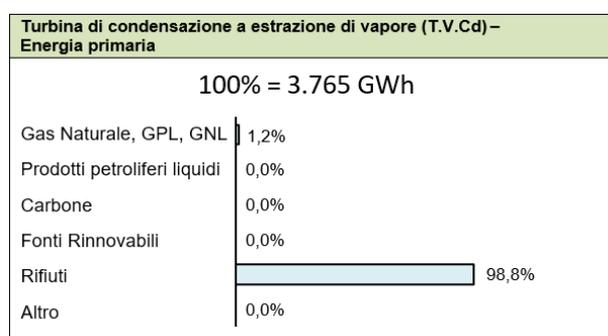
Figura 11 - Energia primaria per T.V.C<sub>d</sub>. ripartita tra le varie tipologie di combustibile.
